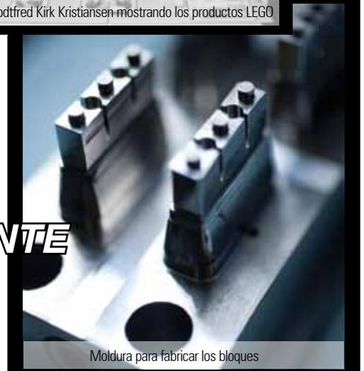
Moldura para fabricar los bloques
