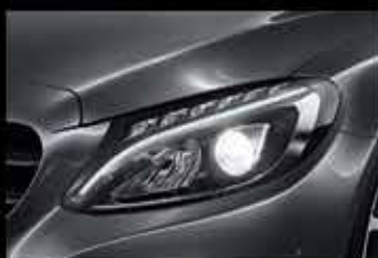
Faros LED High Performance con regulación automática
