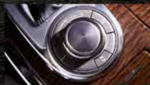
Switch 4x4-I. 3 tipos de conducción: AUTO/4H/4L.
