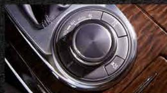
Switch 4x4-i. 3 tipos de conducción: AUTO/4H/4L.
