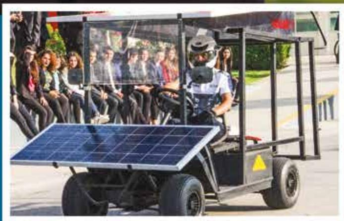
En 2016 nuestros alumnos fabricaron un auto eléctrico de energía solar, capaz de transportar a dos pasajeros a una velocidad hasta 110 km/h.
